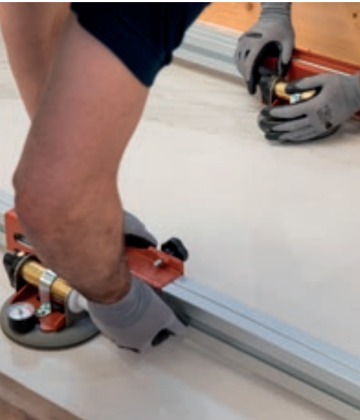
2. Prima della movimentazione accertarsi che le ventose siano fissate e aderiscano perfettamente alla lastra.
