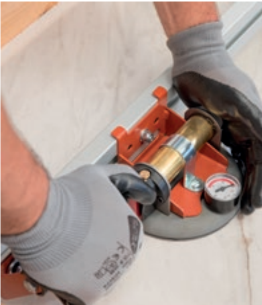
2. Prima della movimentazione accertarsi che le ventose siano fissate e aderiscano perfettamente alla lastra.
