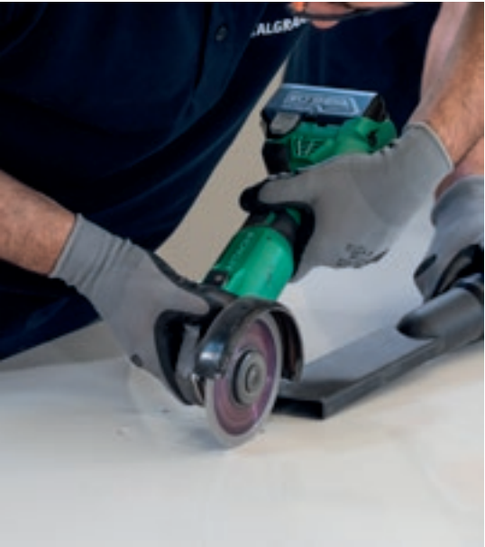
3. Congiungere il foro con l'estremità della lastra attraverso apposita smerigliatrice angolare equipaggiata con disco diamantato.
