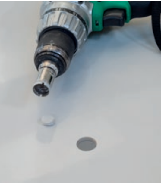
3. Mantenere il trapano/avvitatore ad un angolo di 90° e con una pressione delicata e costante effettuare movimenti circolari con un angolo di circa 5°-10°. Non spingere il trapano/avvitatore dritto verso il basso e accertarsi di avere acqua a sufficienza per bagnare la fresa durante tutta la lavorazione.
