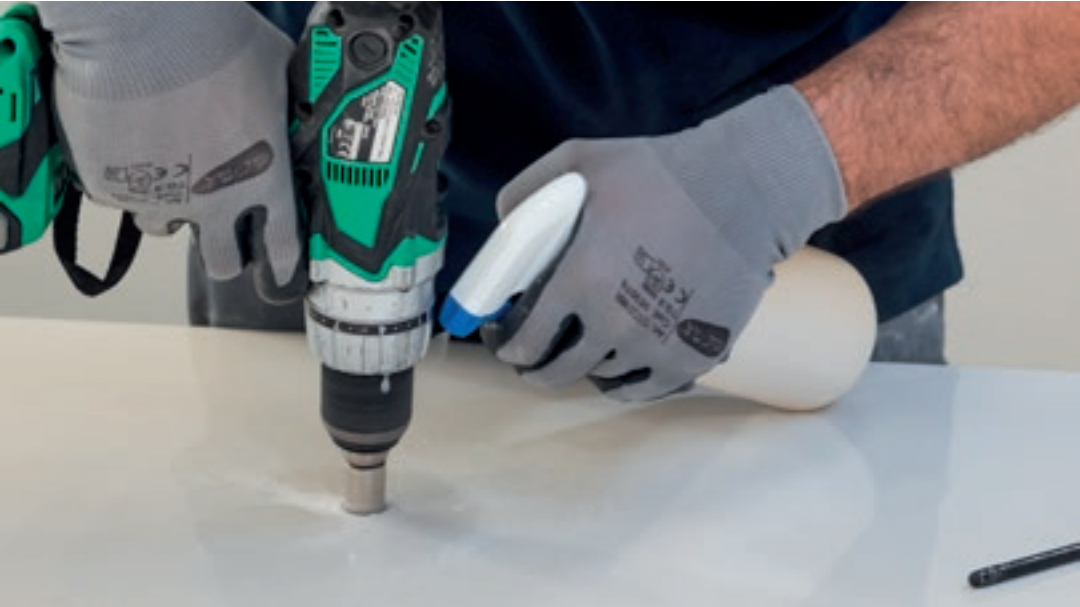
3. Mantenere il trapano/avvitatore ad un angolo di 90° e con una pressione delicata e costante effettuare movimenti circolari con un angolo di circa 5°-10°. Non spingere il trapano/avvitatore dritto verso il basso e accertarsi di avere acqua a sufficienza per bagnare la fresa durante tutta la lavorazione.
