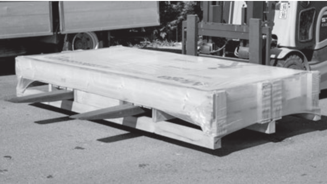
A. Per movimentare correttamente il pallet sul lato lungo si raccomanda di allargare al massimo le forche e di posizionarle al centro del pallet, far presa su tutta la profondità prima di sollevare.
